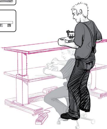
Höhenverstellbare Arbeitstische sorgen am Arbeitsplatz für eine optimale Arbeitshöhe, die individuell vom Bediener eingestellt werden kann.
