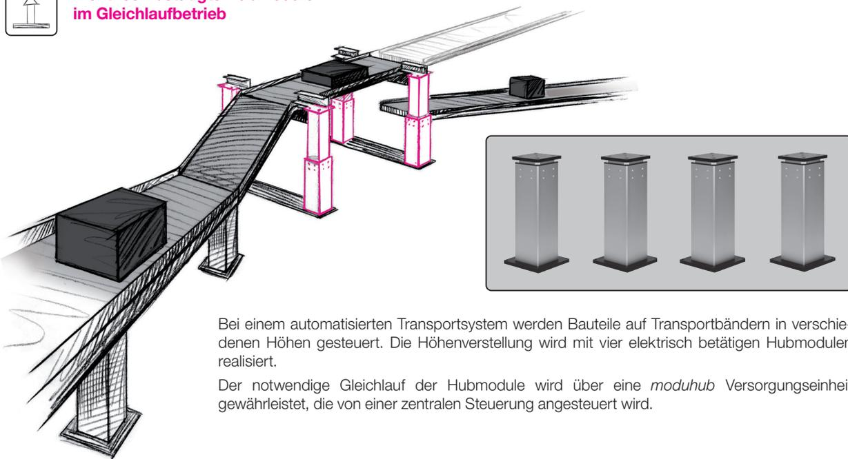
Bei einem automatisierten Transportsystem werden Bauteile auf Transportbändern in verschiedenen Höhen gesteuert. Die Höhenverstellung wird mit vier elektrisch betätigten Hubmodulen realisiert.
