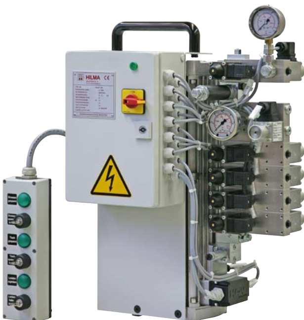
Hydraulikaggregat der Baureihe 7, 2,8 l/min., max. 400 bar
