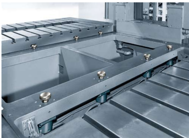
Serrage d'une table de changement au moyen des éléments de serrage à traction.
