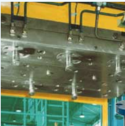
⑨ Kääntösynterit puristimen puskimessa. Työkalu poistettuna, puskin yläkuolokohdassa ja kiinnittimet auki-asennossa
