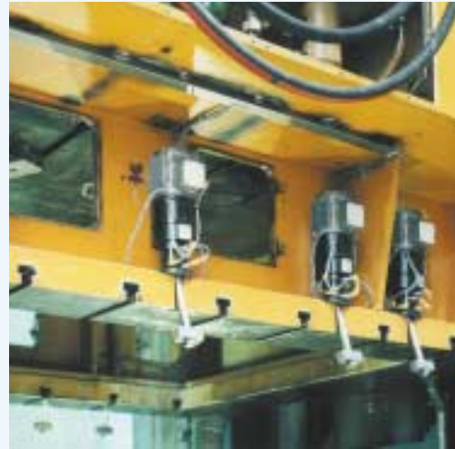
⑧ Nelipilaripuristimeen asennetut sähkömekaaniset kääntösynterit
