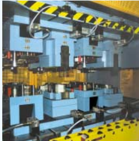
② Pöytään ja puskiin asennetut T-urakiinnittimet. Työkalu tuodaan pöydälle kääntyvien kannatinkonsoolien avulla
