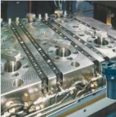
⑦ Uppoavilla kääntösyntereillä varustettu nelipilaripuristin. (männänvarsi ulkona kääntöasennossa)
