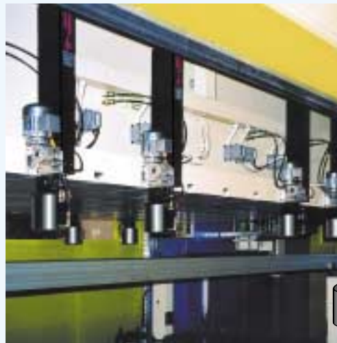
⑥ Nelipilaripuristimen puskiin asennettu, työntöketjulla varustettu automaattinen pikakiinnitysjärjestelmä. Kiinnityselementti: reikämäntäsyllinteri
